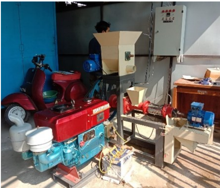
Gambar 13 Mesin Ekstruder Pencetak pakan ikan apung
