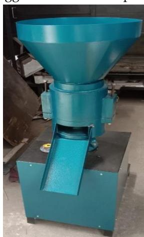
Gambar 5. 1 Peralatan Cetak Pelet Pakan Lele
