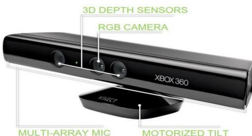
Gambar 4.1. Perangkat Keras Sensor Kinect
